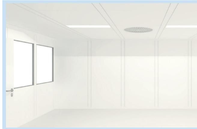
**Bandrasterelemente** werden nur eingesetzt, wenn Türen oder Brüstungsverglasungselemente integriert werden sollen.
