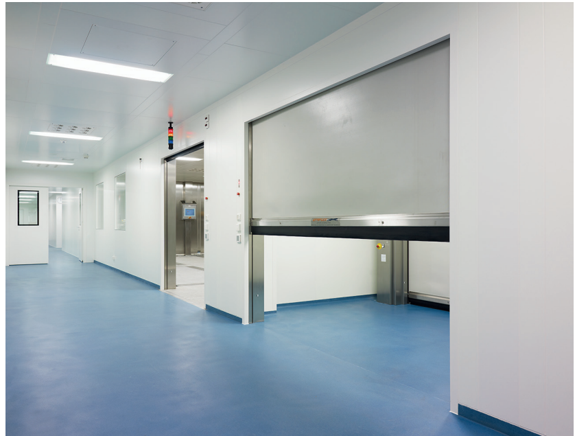
GMP Wandsystem mit Ausschnitten für Rolltore
